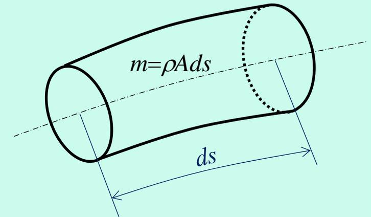
よって  $\partial(mv)/\partial t = \dots$  で式をまとめる場合は、**運動量の流入出の収支のほか、瞬時の力の釣合いを考慮しなければならない。**
