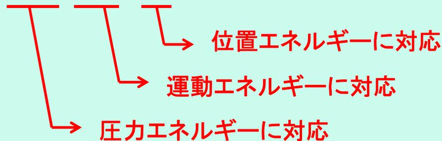
上式に示すベルヌーイの定理は、圧力、運動および位置エネルギーの関係を長さの単位に換算し示している。
