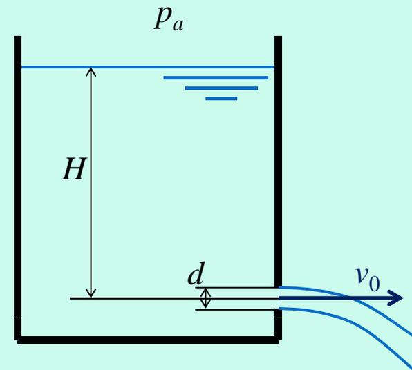
流出する液体の速さは、液体の密度や穴の直径に依存しない。
