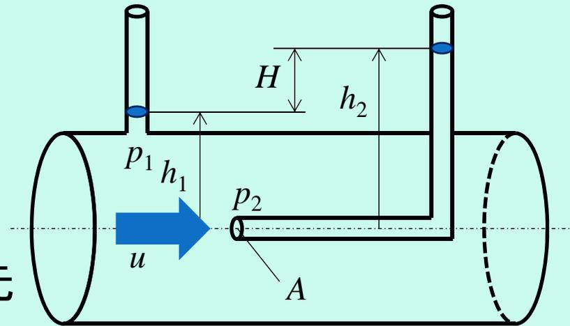
特に、上式の $p$ を**静圧**と呼ぶ。運動エネルギーの圧力換算値である、 $p_v = \rho v^2 / 2$ を**動圧**と呼び、さらに $p_t = p + p_v$ を**全圧**と呼ぶ。
