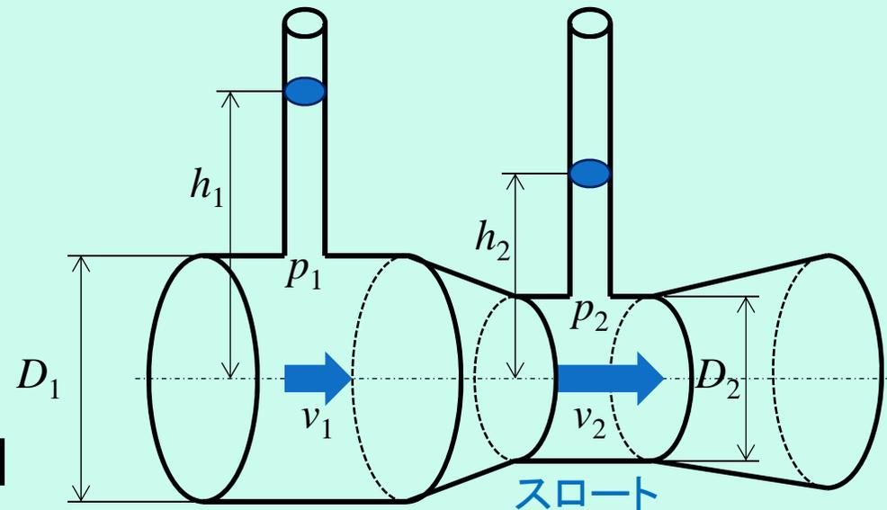
ベンチュリ管を用いることで、**管内の流量(体積流量)**が測定できる。
