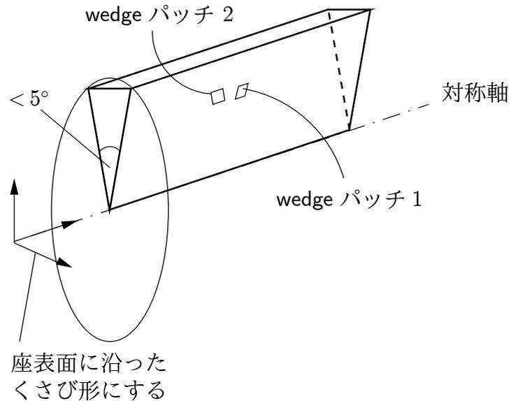
図 5.3 wedge パッチを利用した軸対象形状
