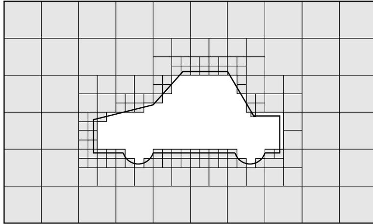
図 5.12 snappyHexMesh メッシュングプロセスにおけるセルの除去
