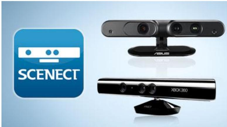
3DスキャナーにKINECTを用いる
