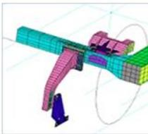
鉄道車両塗油機の振動解析
