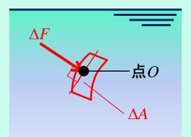
静止流体中の任意の点Oに対し微小面積 $\Delta A$ を仮定したとき、その面に対して垂直に作用する力を  $\Delta F$ とすると、圧力pは次のように定義される。
