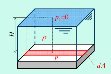
液面に水平な面(面積:A)に作用する力Fは、
