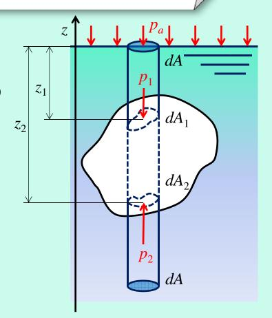
以上の結果より、液体中では、物体が排除した液体の 重量分が鉛直上向きに作用している。 ⇒ 浮力
