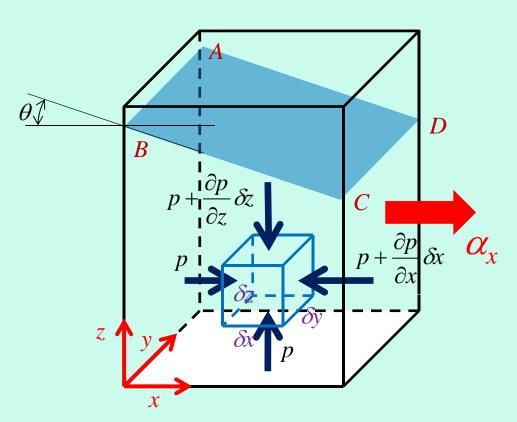
等加速度水平運動では、液面の傾きが分かれば、その加速度が分かる。
