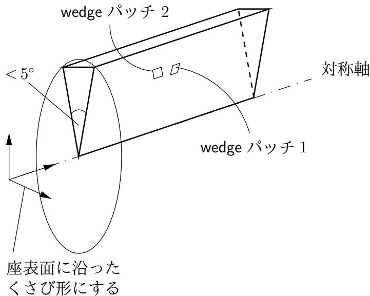
図 5.3 wedge パッチを利用した軸対象形状
