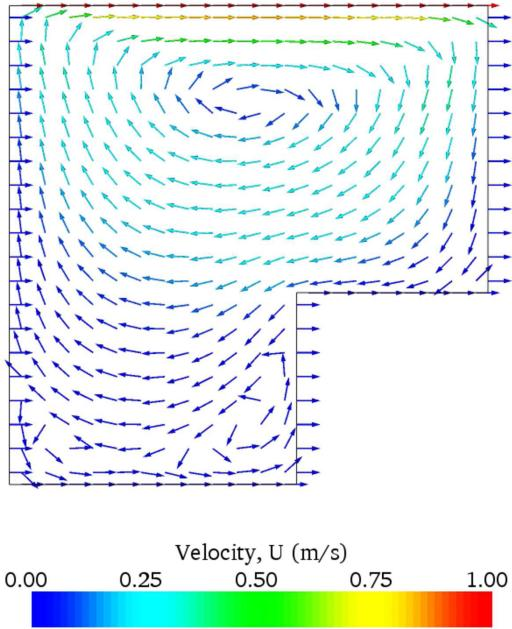
図 2.14 速度場の cavityClipped の解法
