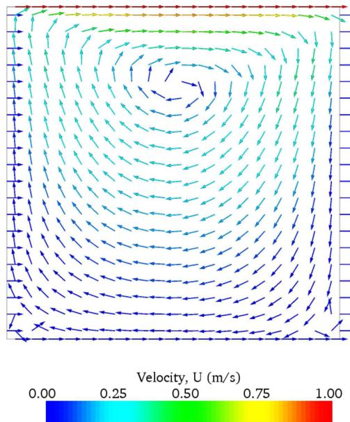
図 2.7 キャビティケースの速度
