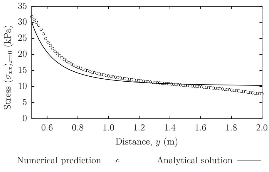
図 2.19 垂直方向対称面における法線方向応力
