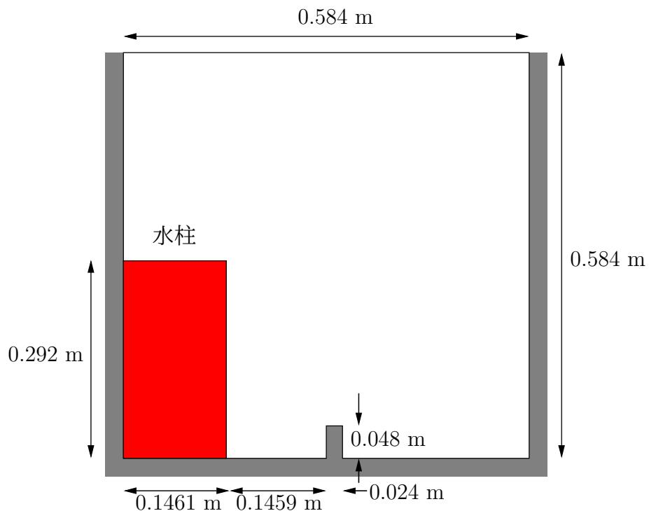
図 2.20 ダム決壊の計算形状
